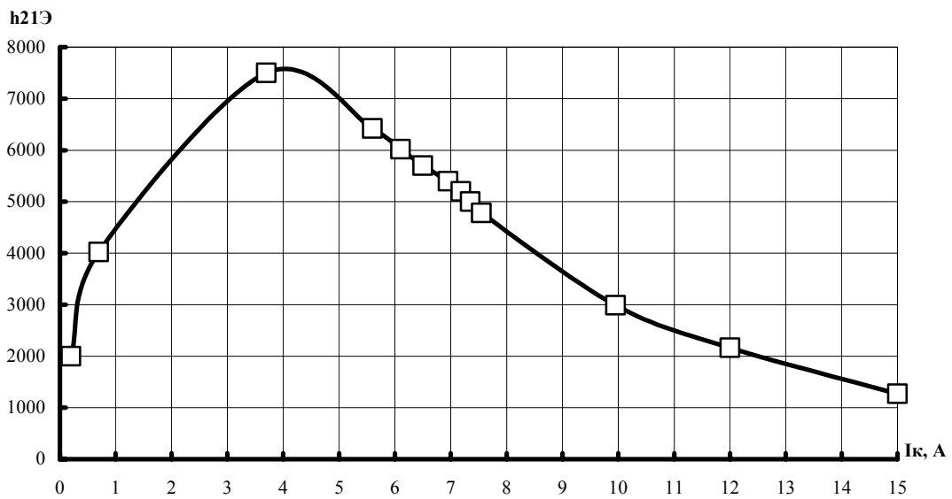
Рис.2 — Зависимость статического коэффициента передачи тока h_{21Э} от тока коллектора при U_{кэ} = 5\text{ В} и T_{корп} = +25\text{ °C}
